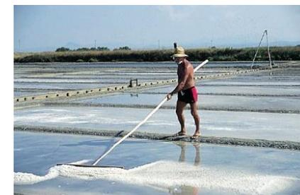
I canali muniti di chiuse trasferiscono l'acqua dalle vasche chiamate **fredde** alle seconde chiamate **vasi coltivi**, di forma rettangolare con un livello di 10 cm, e poi alle terze chiamate **retrocalde** e **calde**. Le **retrocalde** e le **calde** sono quadrate, con un livello di acque di 3/5 cm, ed accostate su due file; le **retrocalde** comunicano col vaso **coltivo** e le **calde** con il vaso **salante**, dove termina la produzione del sale che, frantumato,
